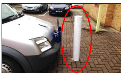
Słupek o długości 1 m przed kamerą zamontowaną na wysokości 0,6 m.
